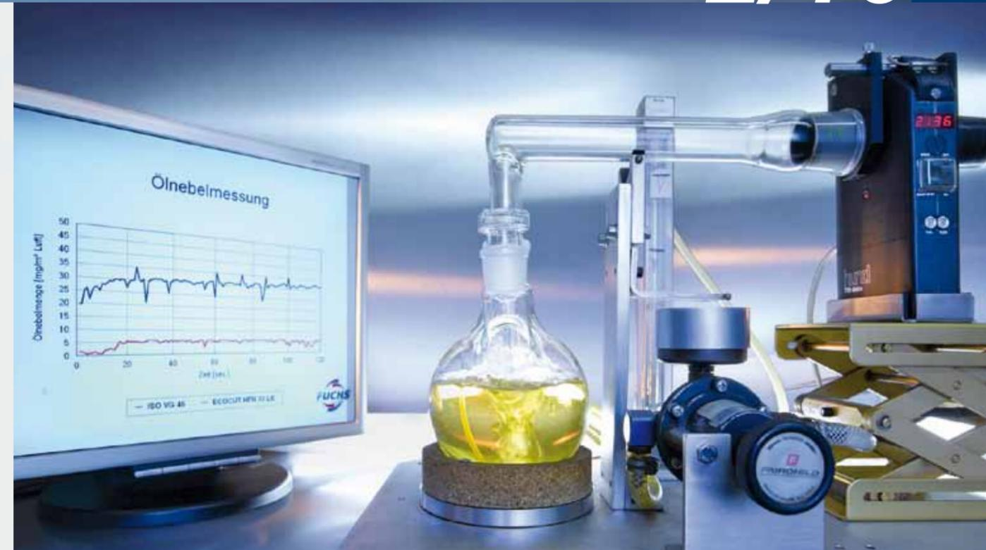
Versuchsaufbau zur Ölnebelmessung nach FUCHS Patent
